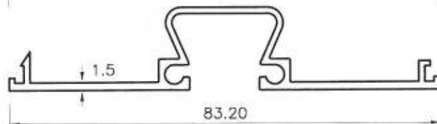
Ⓐ รูปหน้าตัดที่ใช้ขึ้นอยู่กับรูปแบบของการติดตั้งกระจก
